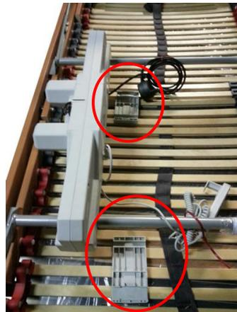
3. Nun können Sie den Motor durch Anheben von der Befestigung ausrasten.
