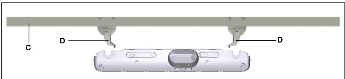
Abbildung 9 Montage des Antriebs
