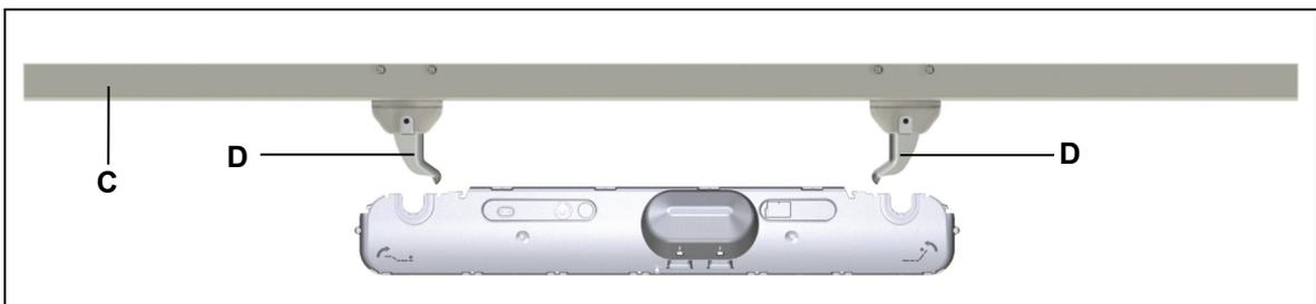
Abbildung 20 Ausbau des Antriebs
