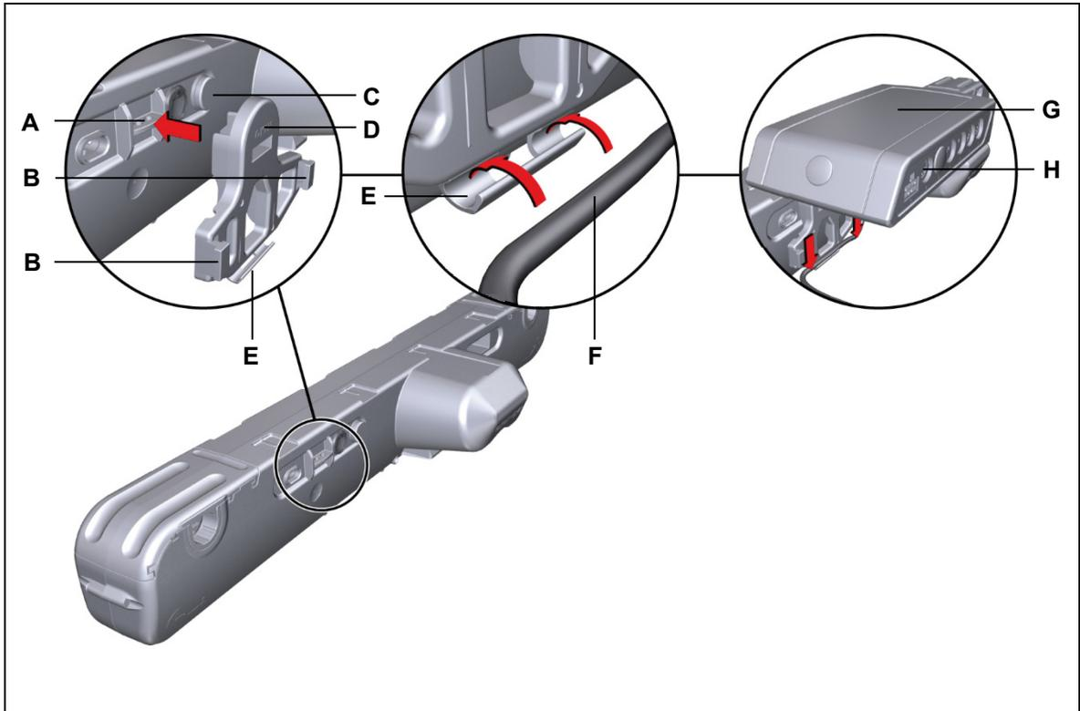
Abbildung 13 Befestigen des Adapters und der HE150
